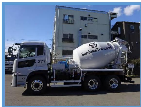
今回のミキサー車も電子直結式12段AT「ESCOT-IV」を搭載して運転手さんをクラッチ操作から解放します。
